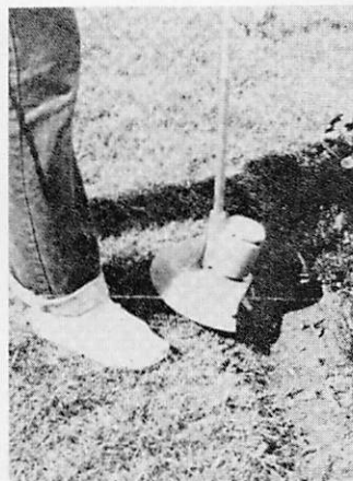
Cet appareil est très pratique car la mince corde de nylon qui tourne à grande vitesse coupe l'herbe dans les endroits difficiles d'accès. Regardez cette femme, elle va au devant des problèmes avec ses sandales. Le manque de précaution dans le choix des vêtements et des souliers peut causer des blessures douloureuses.
